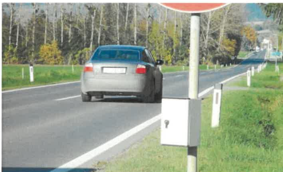
Slika 5.1 – Položaj uređaja Sierzega SR4 prilikom merenja
