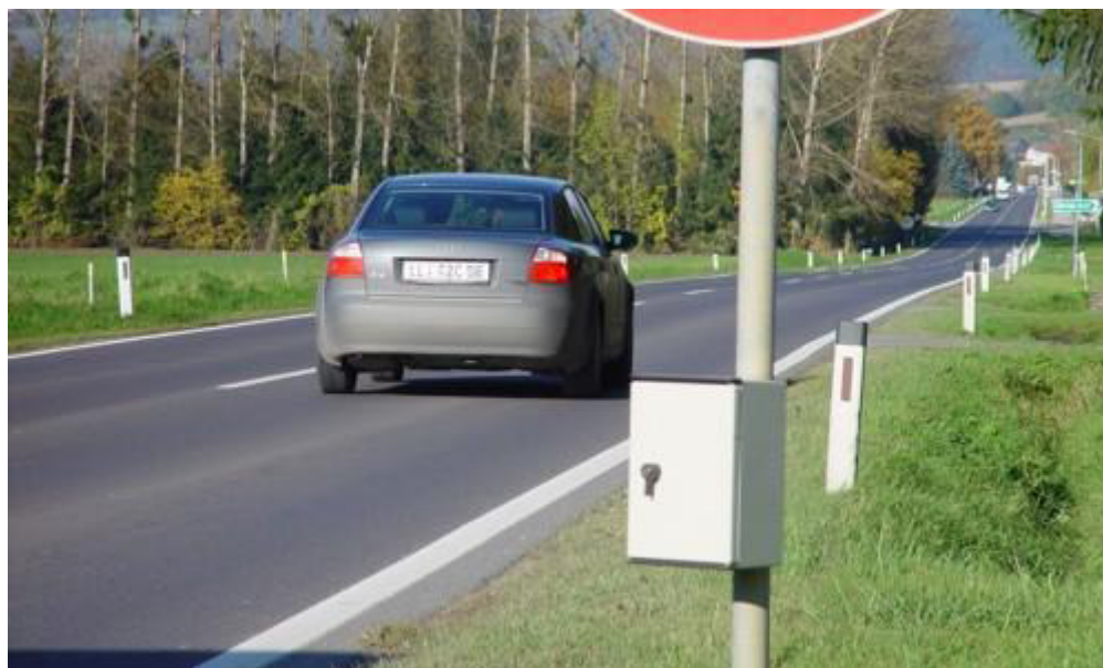
Slika 5.1 – Položaj uređaja Sierzega SR4 prilikom merenja
